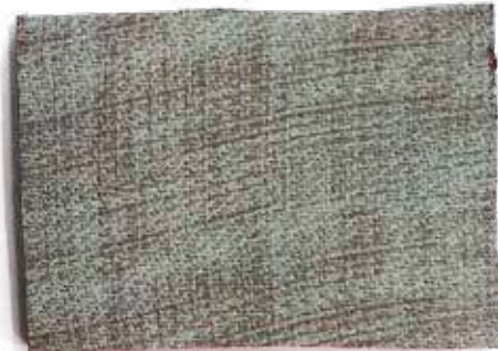
Efecto textil sobre PE Textile Effect on PE Prueba de calor húmedo 3. Damp Heat Test 3.
