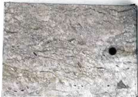
Efecto granito sobre metal Granite Effect on Metal Prueba de niebla salina neutra 4. Neutral Salt Spray Test 4.
